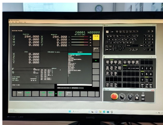
Obr. Nový 4-osý CNC soustruh ve školních dílnách se systémem FANUC
