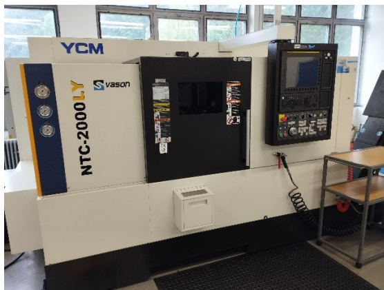
Obr. Nový 4-osý CNC soustruh ve školních dílnách se systémem FANUC
